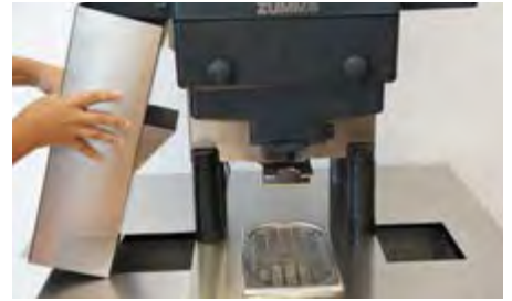
18. Plaats de afvoerkokers.
